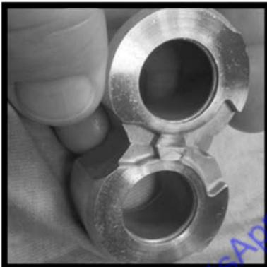
11) Проверить все втулки на задиры или следы перегрева. При необходимости выполнить замену.
