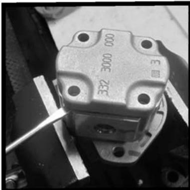
3) Поднять заднюю крышку. Если ее необходимо поддеть, следует соблюдать осторожность, чтобы не повредить поверхности, обработанные на станке.
