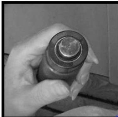
2) Расположить новое уплотнение вала на установочном инструменте так, чтобы пружинная сторона была направлена наружу.
