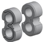
Блоки втулок уплотняют шестерни с торцов. Износ здесь вызовет внутреннее проскальзывание, что приводит к перетечкам масла в насосе.
