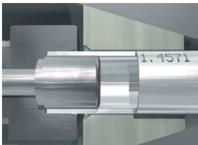
Труба вставляется в станок до упора.
