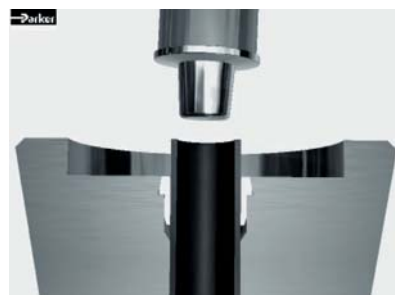
После запуска обработки тискижимают трубу, загибающийся штифт начинает орбитальное и поступательное движение
