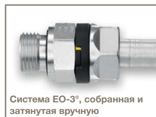
Желтое окошко видно полностью после конечной сборки
