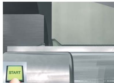
После запуска обработки штамп захватывает трубу и формовочный штифт начинает двигаться вперед
