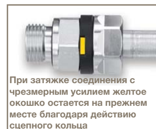
Желтое окошко видно полностью после конечной сборки
