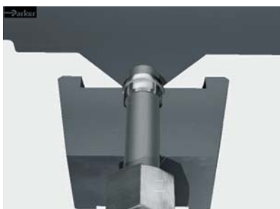
Труба вставляется в инструмент до упора
