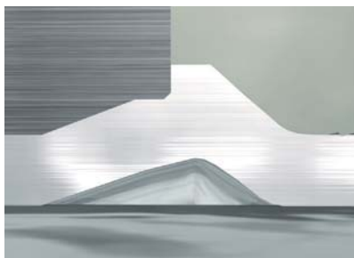
Когда штифт касается зажимных губок, процесс формовки завершен
