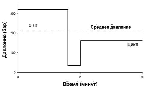
Устройства T7 и T67 могут эксплуатироваться в периодическом режиме при давлениях, превышающих расчетные для непрерывной работы, если взвешенное по времени среднее давление не превышает расчетного давления для непрерывной эксплуатации.
