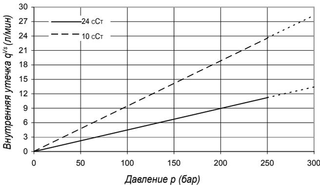
Не включайте насос более чем на 5 секунд при любой частоте вращения и вязкости, если внутренняя утечка на 50% превышает теоретический расход.
