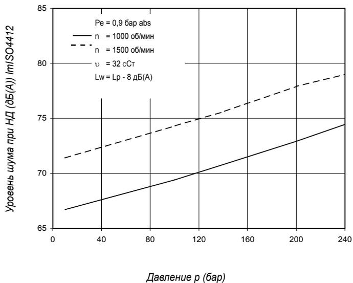
Здесь приводится уровень шума сдвоенного насоса при работе обеих ступеней при уровне давления, указанном на кривой.
