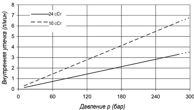
Не включайте насос более чем на 5 секунд при любой частоте вращения и вязкости, если внутренняя утечка превышает 50% теоретической подачи
