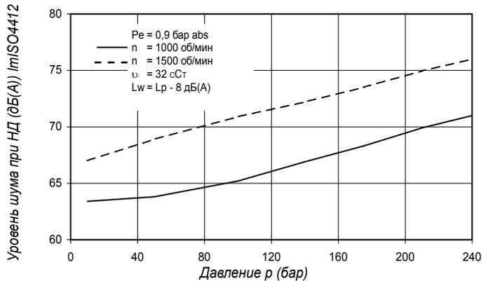
Здесь приводится уровень шума двоярного насоса при работе обеих ступеней при уровне давления, указанном на кривой.
