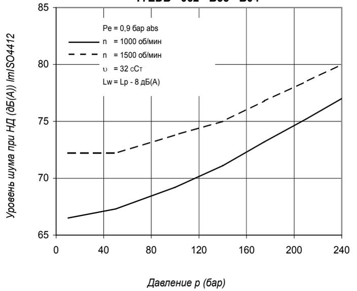
Здесь приводится уровень шума двойного насоса при работе обеих ступеней при уровне давления, указанном на кривой.
