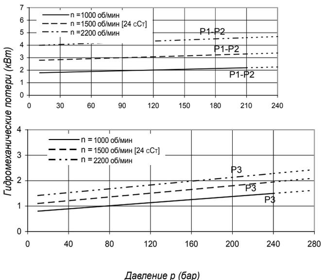
Общая потеря гидромеханической мощности равна сумме потерь каждой ступени при соответствующих условиях эксплуатации.
