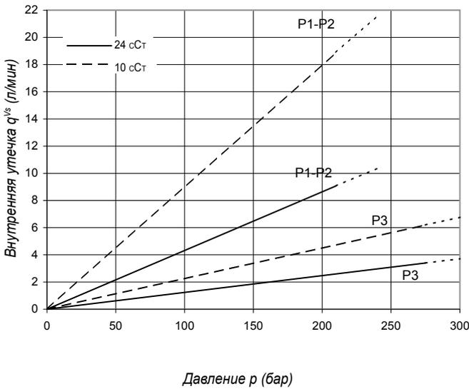
Не включайте насос более чем на 5 секунд при любой частоте вращения и вязкости, если внутренняя утечка на 50% превышает теоретический расход. Общая утечка равна сумме потерь каждого сектора при соответствующих условиях эксплуатации.
