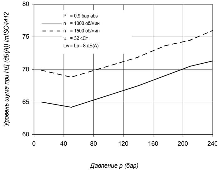
Здесь приводится уровень шума двоечного насоса при работе обеих ступеней при уровне давления, указанном на кривой.
