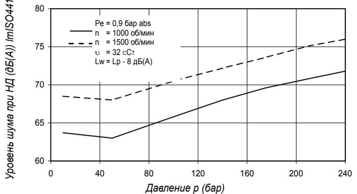
Здесь приводится уровень шума сдвоенного насоса при работе обеих ступеней при уровне давления, указанном на кривой.
