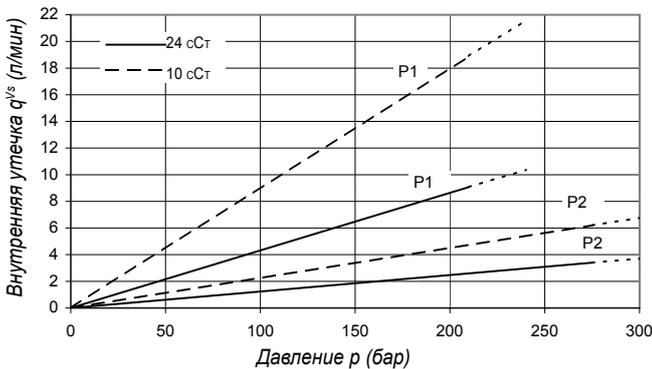
Не включайте насос более чем на 5 секунд при любой частоте вращения и вязкости, если внутренняя утечка на 50% превышает теоретический расход. Общая утечка равна сумме потерь каждого сектора при соответствующих условиях эксплуатации.
