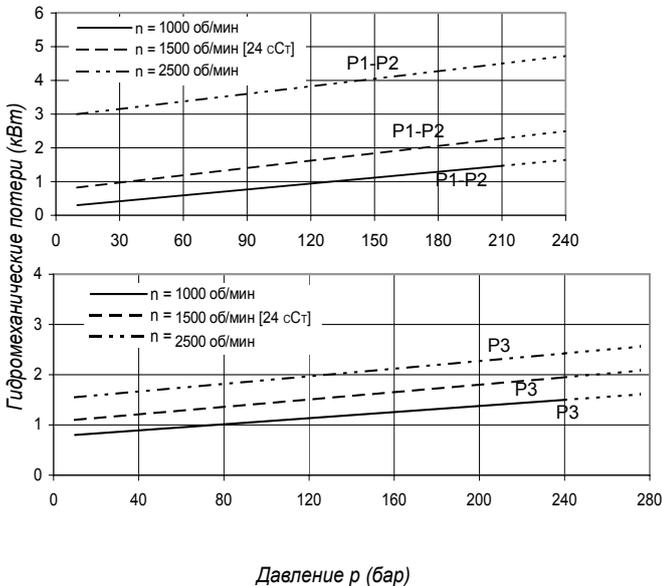
Общая потеря гидромеханической мощности равна сумме потерь каждой ступени при соответствующих условиях эксплуатации.
