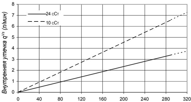
Не включайте насос более чем на 5 секунд при любой частоте вращения и вязкости, если внутренняя утечка на 50% превышает теоретический расход.
