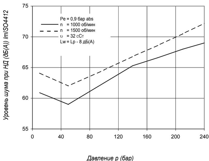
Здесь приводится уровень шума двоярного насоса при работе обеих ступеней при уровне давления, указанном на кривой.
