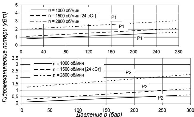
Общая потеря гидромеханической мощности равна сумме потерь каждой ступени при соответствующих условиях эксплуатации.
