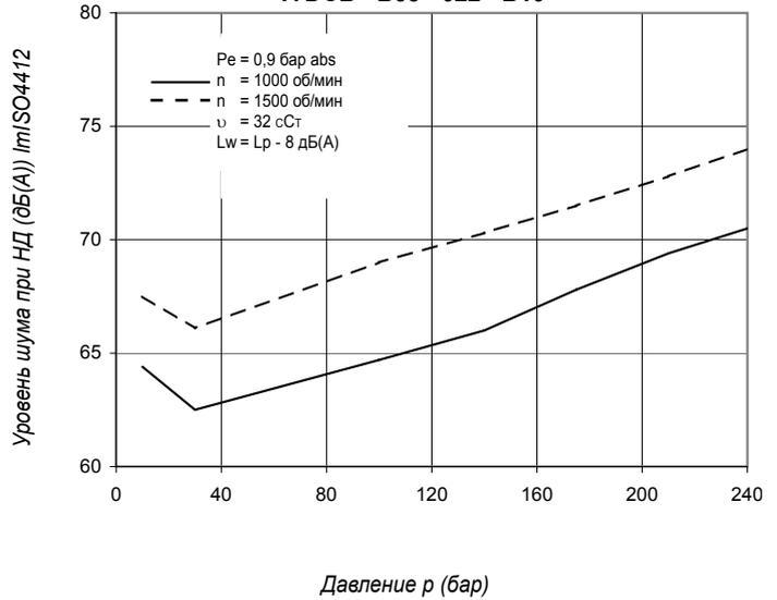
Здесь приводится уровень шума сдвоенного насоса при работе обеих ступеней при уровне давления, указанном на кривой.
