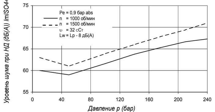
Здесь приводится уровень шума сдвоенного насоса при работе обеих ступеней при уровне давления, указанном на кривой.
