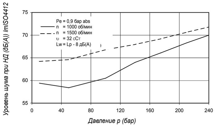
Здесь приводится уровень шума сдвоенного насоса при работе обеих ступеней при уровне давления, указанном на кривой.
