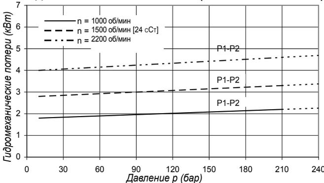
Общая потеря гидромеханической мощности равна сумме потерь каждой ступени при соответствующих условиях эксплуатации.
