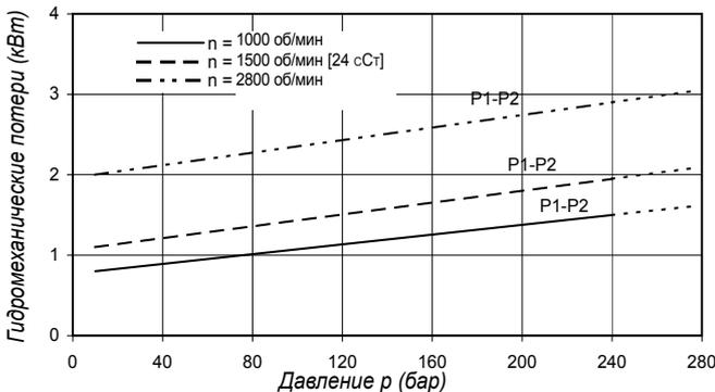
Общая потеря гидромеханической мощности равна сумме потерь каждой ступени при соответствующих условиях эксплуатации.
