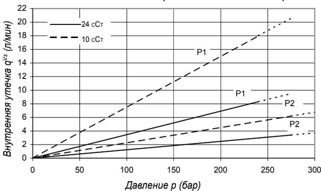
Не включайте насос более чем на 5 секунд при любой частоте вращения и вязкости, если внутренняя утечка на 50% превышает теоретический расход. Общая утечка равна сумме потерь каждого сектора при соответствующих условиях эксплуатации.
