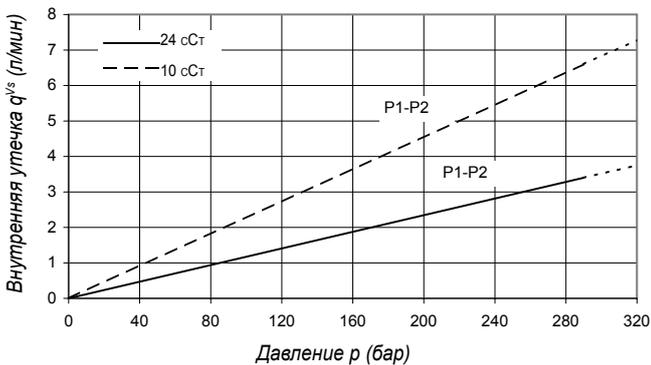
Не включайте насос более чем на 5 секунд при любой частоте вращения и вязкости, если внутренняя утечка на 50% превышает теоретический расход. Общая утечка равна сумме потерь каждого сектора при соответствующих условиях эксплуатации.
