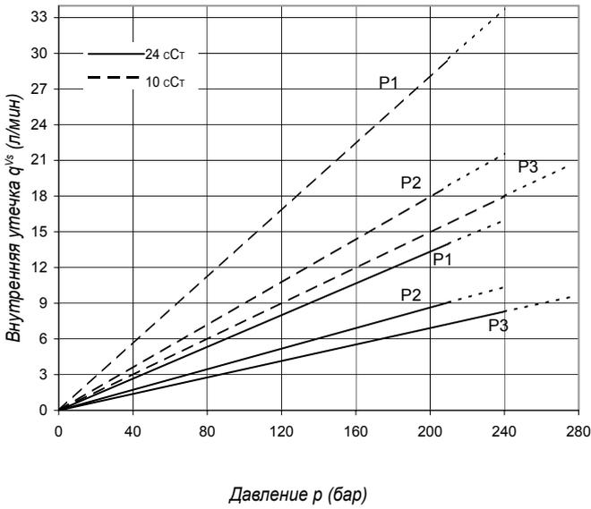
Не включайте насос более чем на 5 секунд при любой частоте вращения и вязкости, если внутренняя утечка на 50% превышает теоретический расход. Общая утечка равна сумме потерь каждого сектора при соответствующих условиях эксплуатации.
